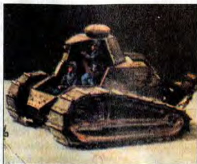
Французский танк FT-17 в разрезе
